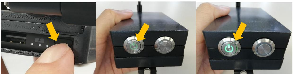
②バッテリー供給スイッチを押します。③LEDが点灯し、起動開始。④明るく点灯したら起動完了です。
