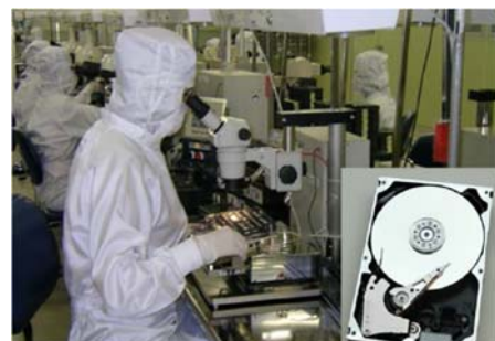
図表 2.1 HDD内部構造とHGAの目視検査の風景
